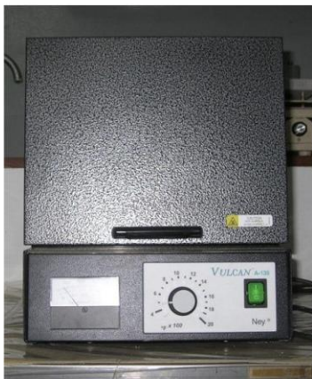
Pemanasan pada suhu 500 °C selama 1 jam
