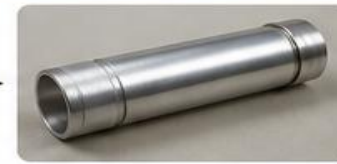
Inner target setelah dilas
