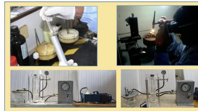
Ampul kuarsa dikemas dalam inner capsule dan ditutup dengan pengelasan pada kedua ujungnya kemudian diuji kebocoran dengan sistem gelembung ( bubble test )
