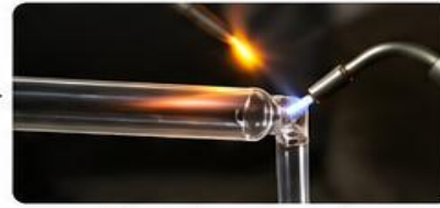
Pengelasan ampul (quartz)
