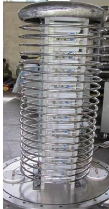
Generator Cockcroft-Walton Buatan PSTA: (kiri) osilator, (kanan) Pelipat Tegangan
