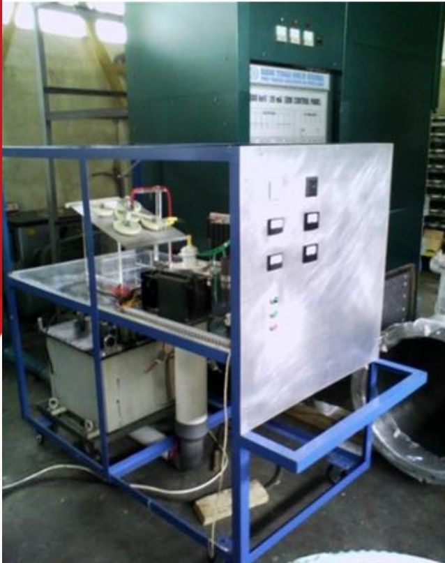
Generator Cockcroft-Walton Buatan PSTA: (kiri) osilator, (kanan) Pelipat Tegangan
