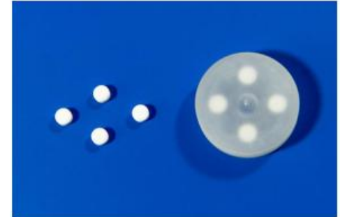
Alanine dosimeter sebagai dosimeter transfer
