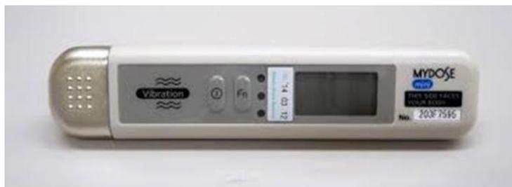
Gambar 18. Dosimeter perorangan dengan jenis detektor semikonduktor yang dewasa ini banyak digunakan
