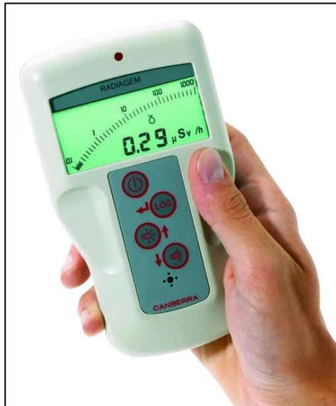
Gambar 14. Surveimeter  $\gamma$  (Gamma) / Sinar-X
