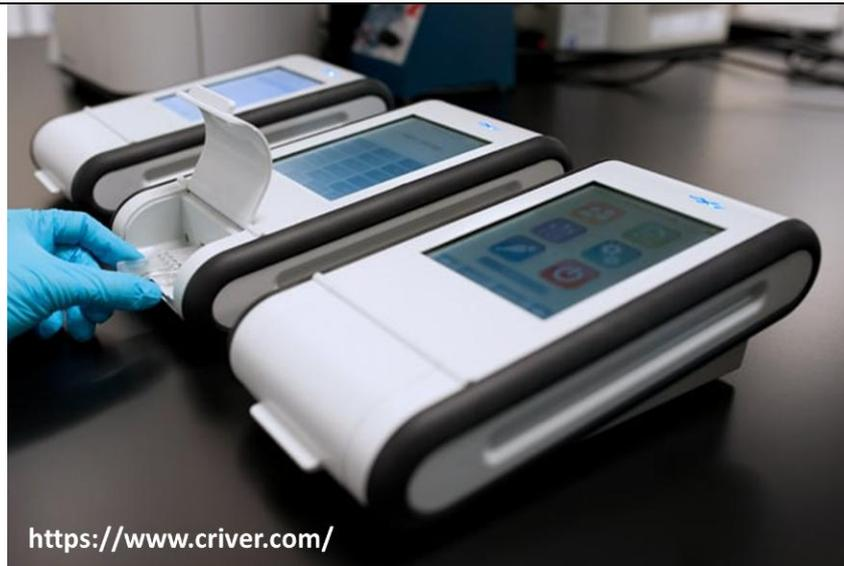
**Gambar 33.** Alat Uji Endotoksin Bakteri
