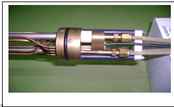
Gambar 74. Dudukan Batang Pemegang Katode dan Sambungan Pendingin
