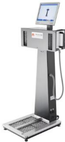
Gambar 36. Hand, Foot and Monitor yang digunakan untuk melakukan pemeriksaan terhadap kaki, dan tangan dari kontaminan alfa, beta dan gamma
