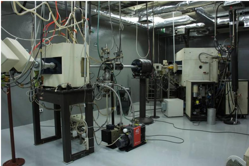
Gambar 13. Sistem transport berkas ( beamline ) pada siklotron CS-30 Sumber: Milik ITRR-DPFK, BRIN
