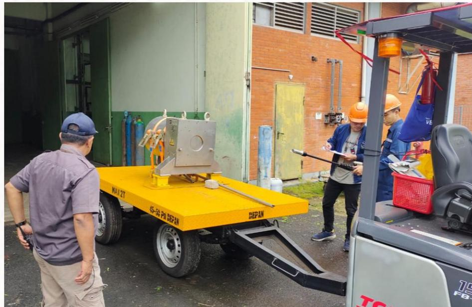
Sistem Transportasi Radioisotop merupakan peralatan-peralatan yang digunakan untuk memindahkan zat radioaktif (radioisotope) dari reaktor ke lab produksi (atau kebalikan) secara selamat dan aman.
