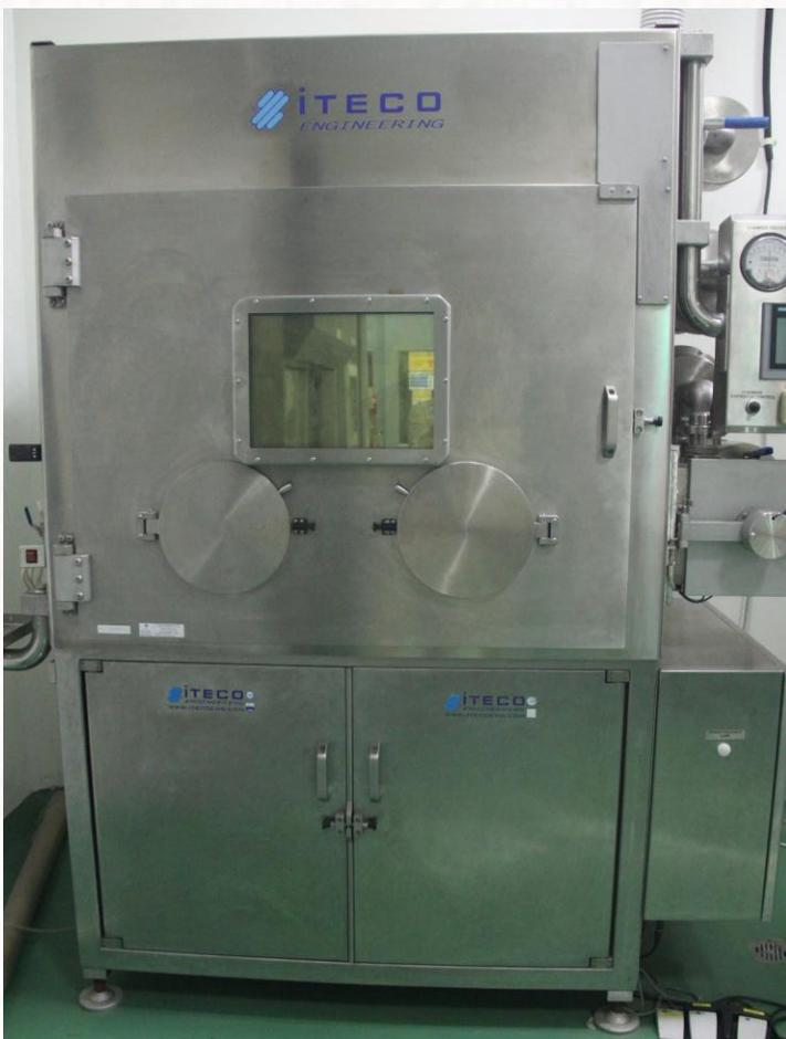
Glovebox memiliki fungsi sama dengan hotcell dan minicell dengan kapasitas menahan radiasi yang lebih kecil. Glovebox didesain secara khusus untuk menangani zat radioaktif tertentu atau produk steril dengan menggunakan sarung tangan karet.
