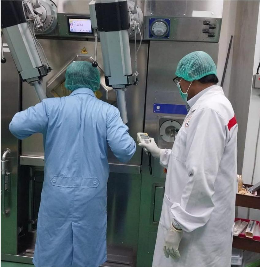
Serupa dengan hotcell, minicell juga merupakan fasilitas tertutup yang memiliki tekanan udara negatif (dari luar ke dalam chamber) dan berpelindung radiasi yang dilengkapi dengan master-slave manipulator (lengan manipulator) untuk memproses material zat radioaktif.
