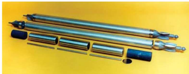
Gambar 3.2. Bahan bakar TRIGA 2000 dan reaktor Kartini
