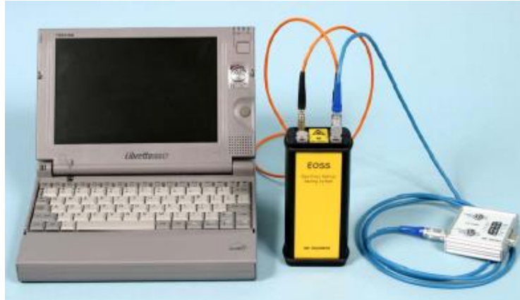
Gambar 6. Sistem penyegelan aktif berupa EOSS
