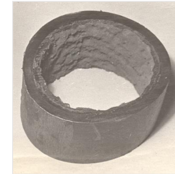
Slag on pipeline
