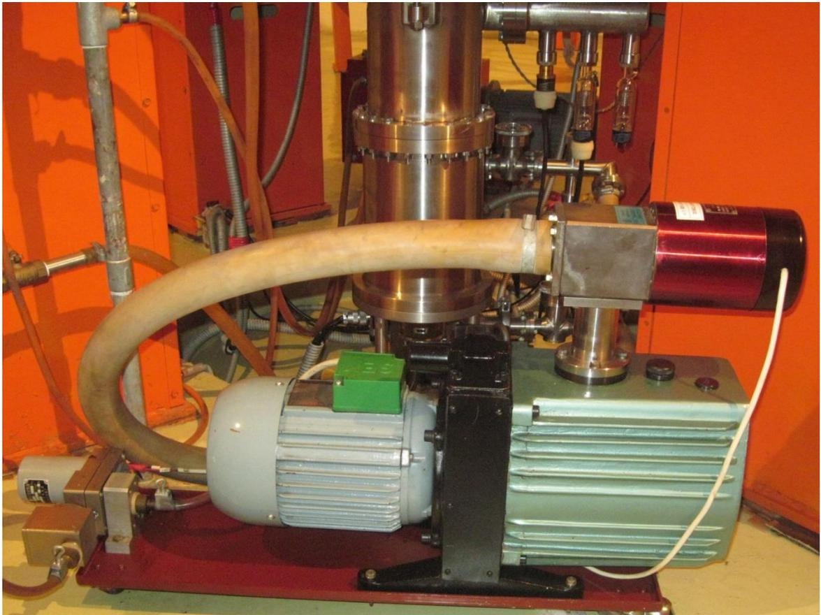
Gambar : Pompa rotary dan pompa turbomolekul
