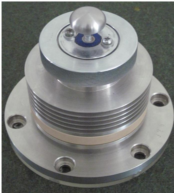
Gambar : Elektron Gun (MBE GJ-2)
